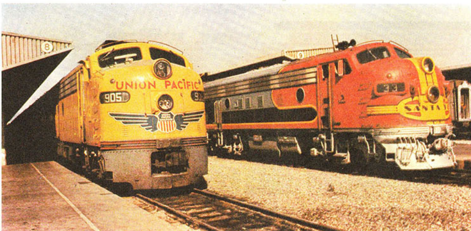
အမေရိကန် ဒီဇယ်-လျှပ်စစ် စက်ခေါင်း အချို့ သည် မြန်ပြီး အားကောင်းသည်။ တခါတရံ ၂ ခေါင်း၊ ၃ ခေါင်း သို့မဟုတ် ၄ ခေါင်း ဆက်ပြီး စွမ်းအား ပိုယူကြသည်။ ရှေ့ဆုံးခေါင်းကို အေ ယူနစ်ဟု ခေါ်သည်။ ၎င်းတွင် ယာဉ်မောင်းခန်း ပါသည်။ နောက်ခေါင်း ဘီ ယူနစ်များ တွင် ယာဉ်မောင်းခန်း မပါ။ ၎င်းတို့သည် အနည်းငယ် သာ လှုပ်ရှားနိုင်သည်။
