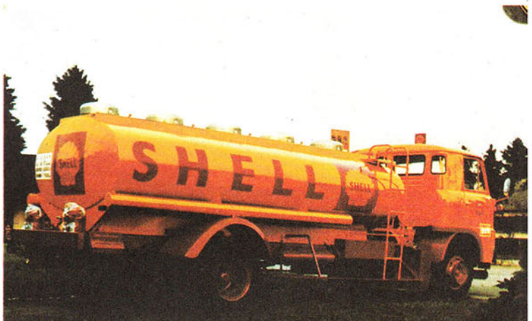
ကုန်းလမ်းအရည်သယ်ယာဉ်များကို ဓာတ်ဆီ၊ ဘီယာတို့ကို သယ်ဆောင်ရာတွင် သုံးပြီး အလားတူယာဉ်များကို ဓာတ်ဆေးမှုန့်၊ ကောက်ပဲသီးနှံနှင့် သကြားတို့ကို သယ်ဆောင်ရာတွင် သုံးသည်။
