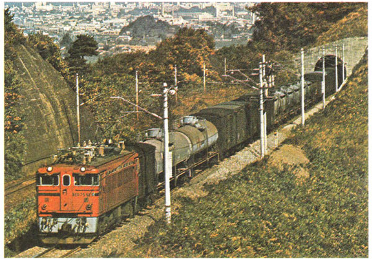
ဂျပန် 'အီးဒီ ၇၅' စက်ခေါင်းများကို ပင်မရထားလမ်းတွင် ခရီးသည်နှင့် ဝန်တင်ရထားဆွဲရာ၌ သုံးသည်။ နှစ်ပေါင်းများစွာ ထင်ရှားခဲ့သော စွမ်းရည်ကြောင့် နောက်ပိုင်းတွင် ထုတ်လုပ်သော စက်ခေါင်းများ၏ စံနမူနာ ဖြစ်သည်။
