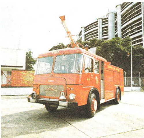
ဆီလောင်မီးကိုသတ်ရန် အမြှုပ်ပန်းကျက်ပါမီးသတ်ကား ညမီးသတ်ရာတွင် အသုံးပြုသော မီးမောင်းပါယာဉ် ရေစုပ်စက်ယာဉ်သည် ရေကို အရှိန်ပြင်းစွာပို့ထုတ်နိုင်သည်။ ရေလွှမ်းသောဒေသ၌လည်း ရေကို စုပ်ထုတ်နိုင်သည်။
