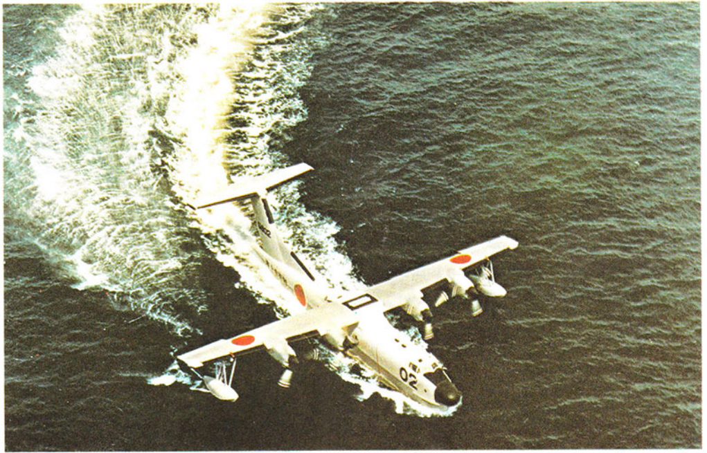
မိုးပုံယာဉ်များတွင် ရေလုံကိုယ်ထည်ရှိသည်။ ရေပြင်မှ ပျံတက်နိုင်သည်။ ကုန်း-ရေသုံးလေယာဉ်များသည် ဆင်းသက်ဘီးရှိသဖြင့် ကုန်းနှင့်ရေမှ ပျံတက်နိုင်သည်။
