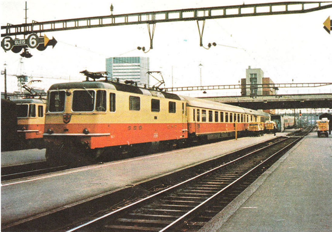
'ဆွစ်ရီ ၄/၄' စက်ခေါင်းများသည် သေးသော်လည်း အားကောင်း၏။ တောင်ထူသော ဒေသတွင် သုံးသည်။ တစ်နာရီလျှင် ကီလိုမီတာ ၁၄၀ အထိ ပြေးသည်။
