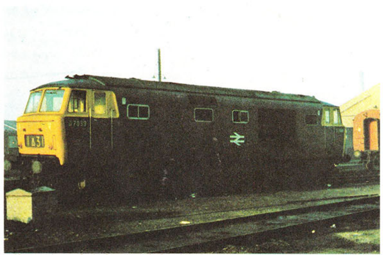
မြိတ်သျှ '၃ နံပါတ် ဒီ ၇၀၇၉' ဒီဇယ်-ဟိုက်ဒရောလစ် စက်ခေါင်းကို ဗေယာ ပီကော့အလုပ်ရုံက တည်ဆောက်ခဲ့၏။ ဂျာမနီ 'မိုင်ဗတ်' အင်ဂျင်ကို သုံး၏။
