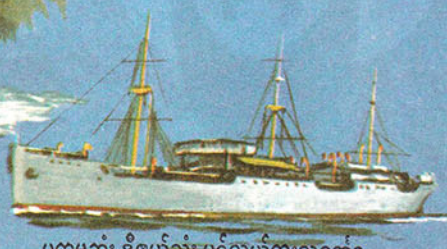
ပထမဆုံး ဒီဇယ်သုံး ပင်လယ်ကူးသင်္ဘော ဆီလန်ဒီယာ (၁၉၁၁)
