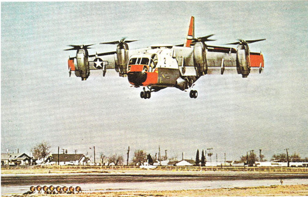
လိုရာဘက်သို့ပျံရန် အယ်လ်ဘီဗီ ဟိလာလီယင် အိက်စ်စ် - ၁၄၂ အေ၏တောင်ပံနှင့်အင်ဂျင်ကို စောင်းပေးရ၏။
