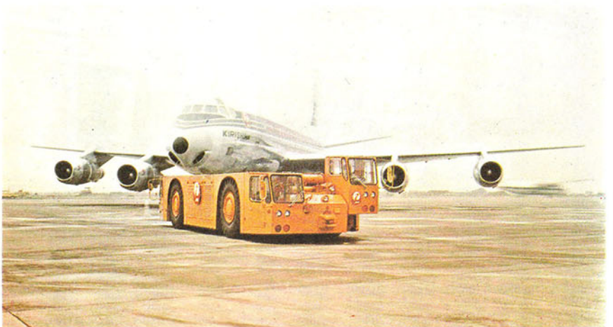
ဆွဲထရက်တာသည် အသုံးများသည်။ လေယာဉ်ကွင်းတွင် လေယာဉ်ကို လိုရာဆွဲပို့သည်။ တန် ၃၀၀ ရှိ အရှင်ဆက်ထားသောလော်ရီကြီးကို စက်မှုလုပ်ငန်းတွင် သုံးသည်။ အား ကောင်းပြီး လှုပ်ရှားရလည်း လွယ်သည်။
