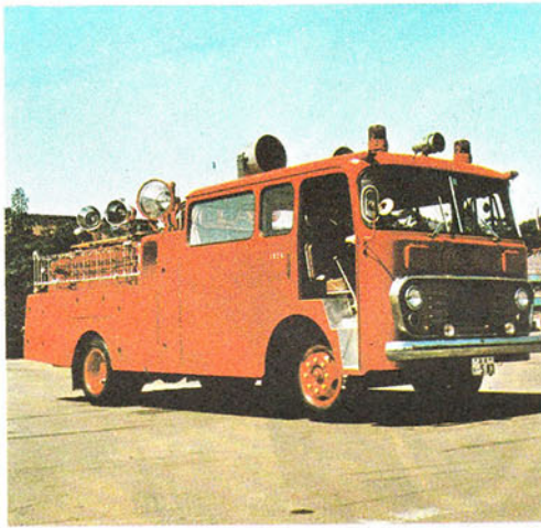
ဆီလောင်မီးကိုသတ်ရန် အမြှုပ်ပန်းကျက်ပါမီးသတ်ကား ညမီးသတ်ရာတွင် အသုံးပြုသော မီးမောင်းပါယာဉ် ရေစုပ်စက်ယာဉ်သည် ရေကို အရှိန်ပြင်းစွာပို့ထုတ်နိုင်သည်။ ရေလွှမ်းသောဒေသ၌လည်း ရေကို စုပ်ထုတ်နိုင်သည်။
