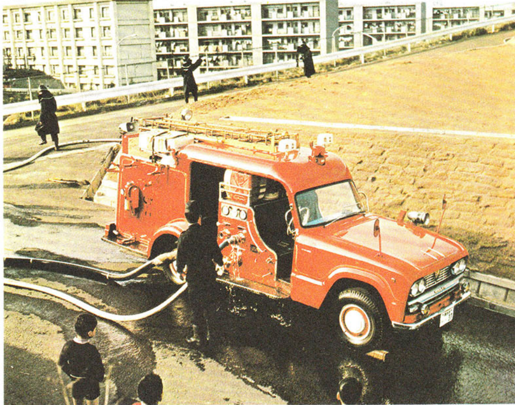
ဆီလောင်မီးကိုသတ်ရန် အမြှုပ်ပန်းကျက်ပါမီးသတ်ကား ညမီးသတ်ရာတွင် အသုံးပြုသော မီးမောင်းပါယာဉ် ရေစုပ်စက်ယာဉ်သည် ရေကို အရှိန်ပြင်းစွာပို့ထုတ်နိုင်သည်။ ရေလွှမ်းသောဒေသ၌လည်း ရေကို စုပ်ထုတ်နိုင်သည်။
