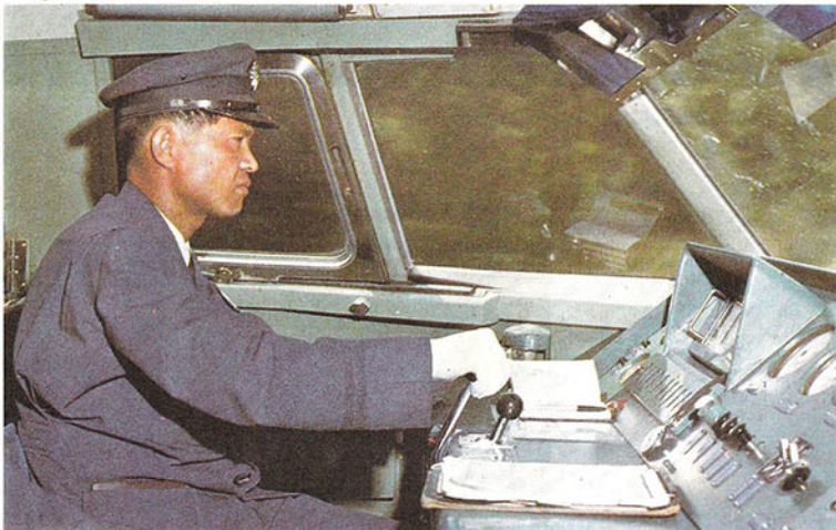
ဤစမ်းသပ်ရထားသည် ဂျပန်နိုင်ငံ၏ လိုင်းသစ်တစ်ခုအတွက် ဖြစ်သည်။ ပေါ့ပါးစေရန် ကိုယ်ထည်ကို အလူမီနီယမ်ဖြင့် ပြုလုပ်ထားသည်။ ထို့ကြောင့် တစ်နာရီလျှင် ကီလိုမီတာ ၂၅၀ အထိ သွားနိုင်သည်။ မော်တာနှင့် ဘရိတ်များမှာ ယခင်ရထားများထက် အားပိုကောင်းသည်။ ဤရထားကို စတင်အသုံးပြုလာသောအခါ ၎င်းသည် တိုးတက်ပြီးသော ဂျပန်မီးရထားစနစ်ကို ထပ်မံတိုးတက်စေလိမ့်မည်။
