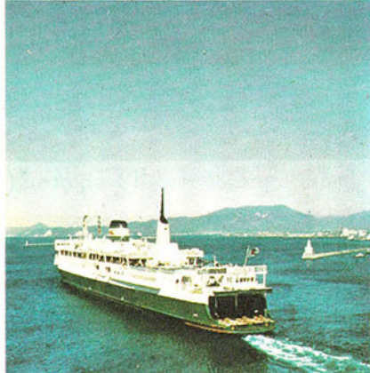
ပန်ကာရွက်အနေအထားပြောင်းခြင်းဖြင့် သင်္ဘောဦးတည်ဘက် ပြောင်းနေစဉ်
